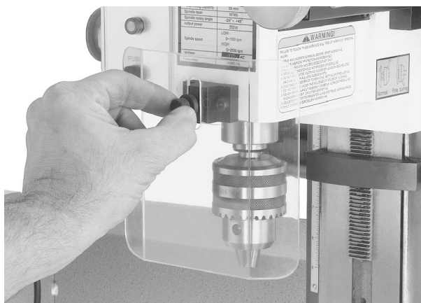
Fig. 3 Montering av øyevernsskjerm på fres/borehodet.
