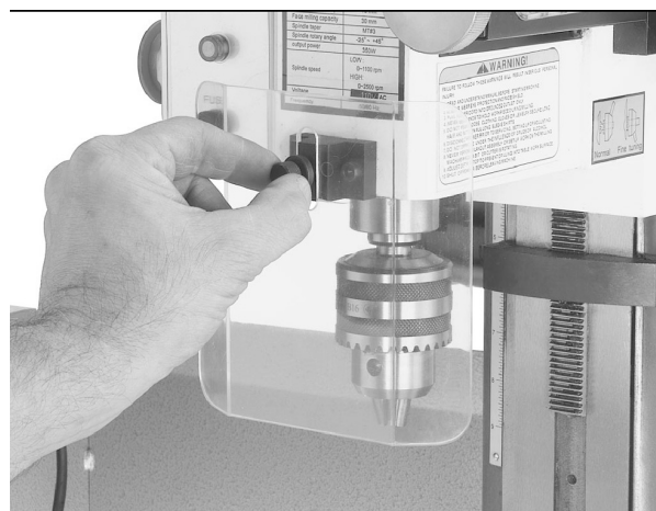
Rys. 3. Mocowanie ekranu ochrony oczu do głowicy frezarsko-wiertarskiej.
