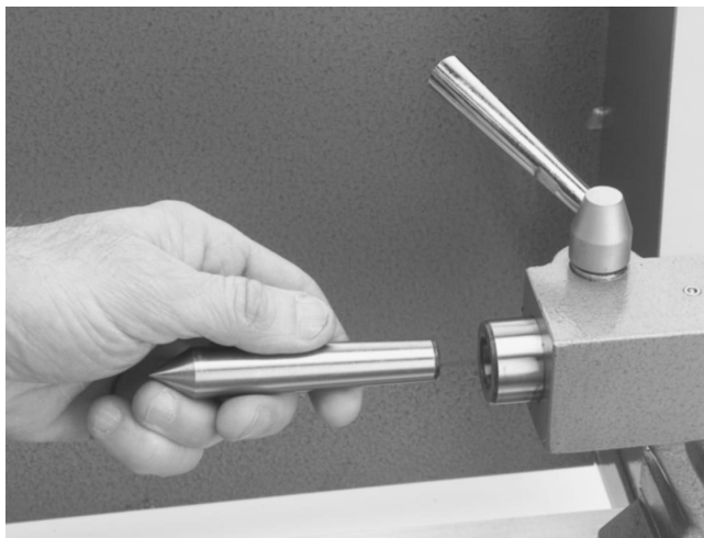
Nekustīgā centra ievietošana aizmugurējā balsta cilindrā
