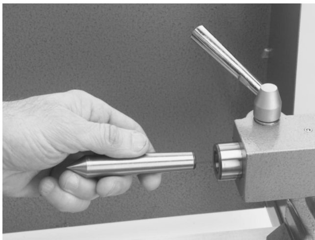
Kärjen asentaminen pinooliin
