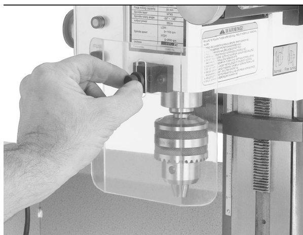
Joonis 3. Silmade kaitsekraani kinnitamine frees-/puurpea külge.
