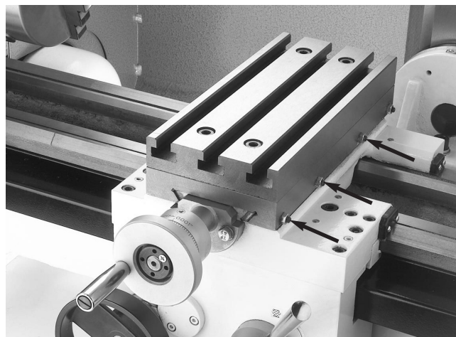
Skruer til føringsliste for tværslæde
