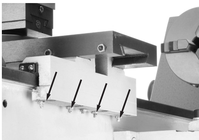
Skruer for føringslister bagtil på slæde
