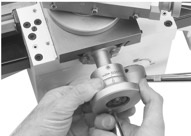
Indstilling af skala på håndhjul
