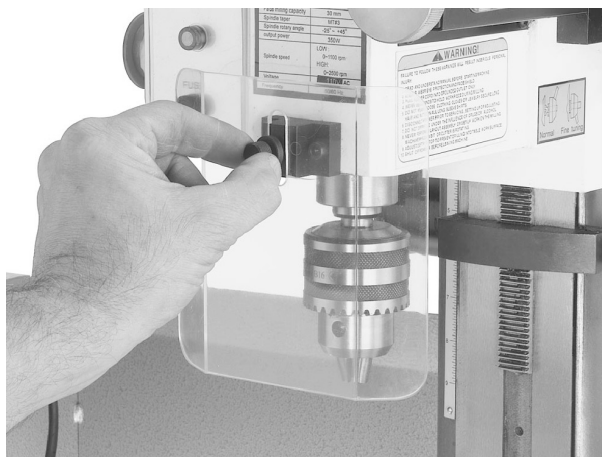
Fig. 3 Montering af øjenbeskyttelses skærm på fræse/borehovedet
