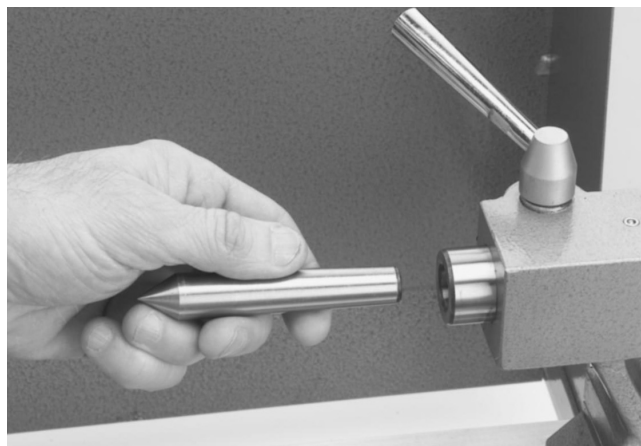
Indsætning af fast pinol i pinolrør
